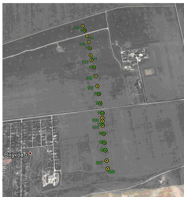
Рис. 1. Схема маршрута проведения спектрометрической съемки на Глебовском газовом месторождении 28 мая 2010 г. (22 точки с номерами 95–116)
