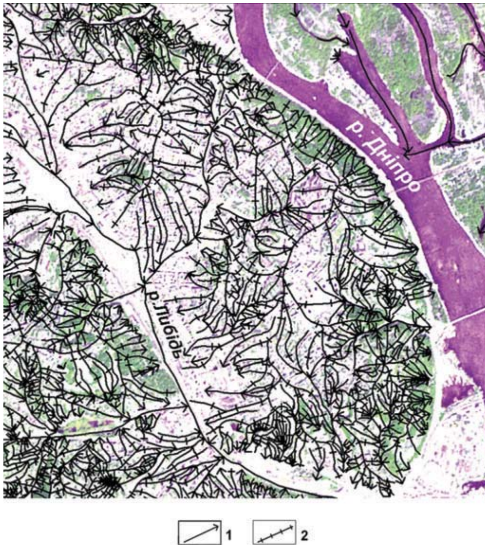
Рис 2. Каркасна структура рельєфу Придніпровської зсувної зони в м. Києві 1 – кільові лінії, 2 – гребеневі лінії
