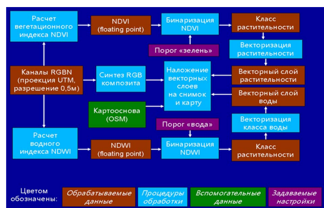
Рис. 5. Основные этапы тематической обработки спутниковых снимков
