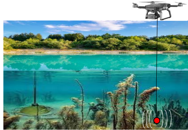
Рис. 7. Фрагмент спеціалізованого синхронного моніторингу та безконтактного виявлення металевієї протидесантної міни ПДМ-1М (заглиблення міни від поверхні води до її штанги від 0,1 до 0,9 м) на потенційно забрудненому ВВП прибережному мілководді акваторії: використання портативного багатопроменевого гідролокатора (разом із належним програмним забезпеченням) у складі пошукового БпЛА
