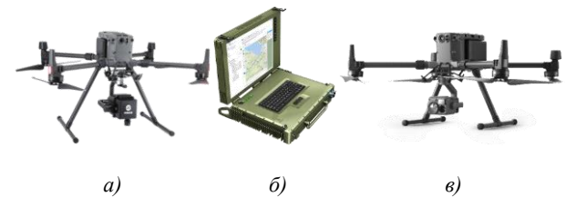
Рис. 5. Квадрокоптери з багатоспектральною камерою (а), з дуальною камерою видимого/інфрачервоного діапазонів (в), а також захищена портативна робоча станція (б)
