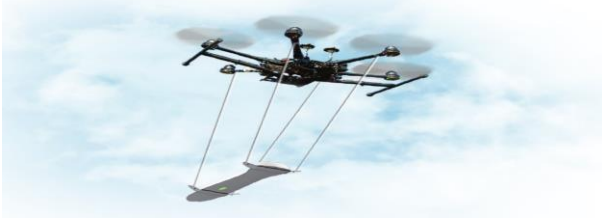
Рис. 6. Модуль магнітометричних засобів виявлення ВВП з магнітометром MagArrow
