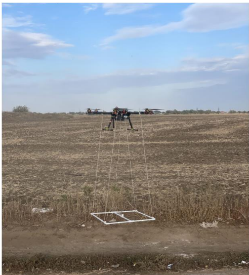
Рис. 1. Дрон, обладнаний металошукачем
