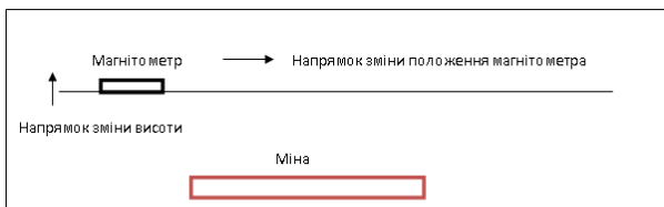
Рис. 6. Схема проведення вимірювань магнітної сигнатури міни
